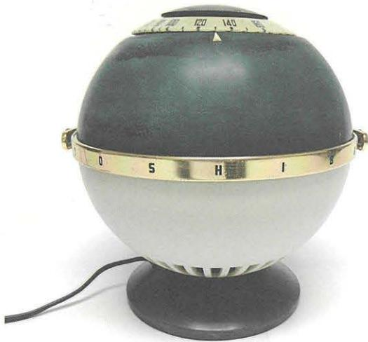
▲「水星型」真空管ラジオ(東芝,昭和31年)。球体の底面にスピーカーが下向きに設置されており、360°全方位に音がひろがる。愛称は「マーキュリー」(水星)。
