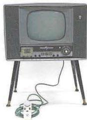
▲時計・リモコン付テレビ「パレード」(早川TD-80, 昭和33年) 有線リモコンの長さは5m。画面左下にはアナログ時計が付属。
